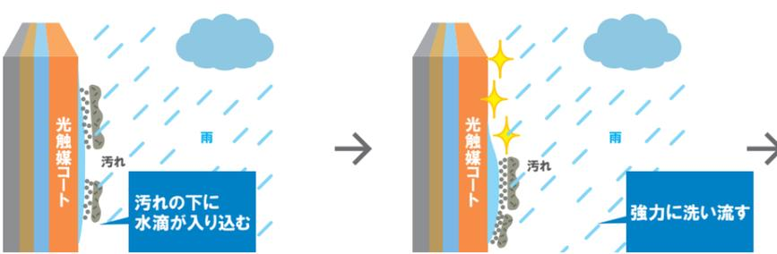
\*光触媒コートは、親水コートの親水性を超えた超親水性。汚れの下に雨水が入り込み、汚れを強力に洗い流します。
