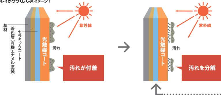
**超親水性\*** 〈雨の日に〉水に非常になじみやすく汚れを雨水が浮かして洗い流します。
