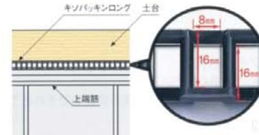
換気スリットを外側と内側で互い違いに設けることにより、換気孔の縫幅が最大16mmまで広がり、より高い換気性能を実現しています。
