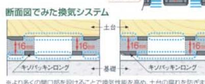
※より多くの開口部を設けることで換気性能を高め、土台の腐れを防ぎます。
